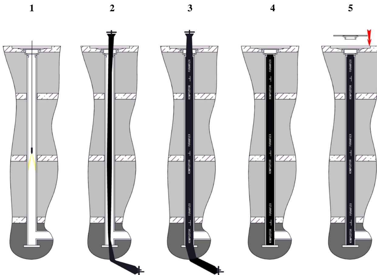
Рис. 2 Этапы установки материала Фуранфлекс®
